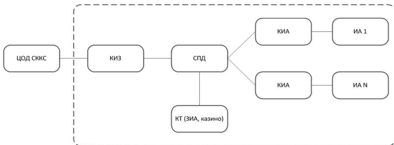
Рисунок 2. Структурная схема подсистемы подключения ЗИА и казино
