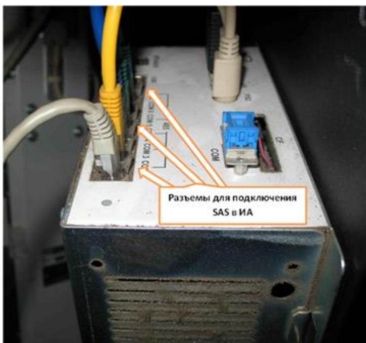
Рисунок 3.4.2 – Подключение канала SAS
