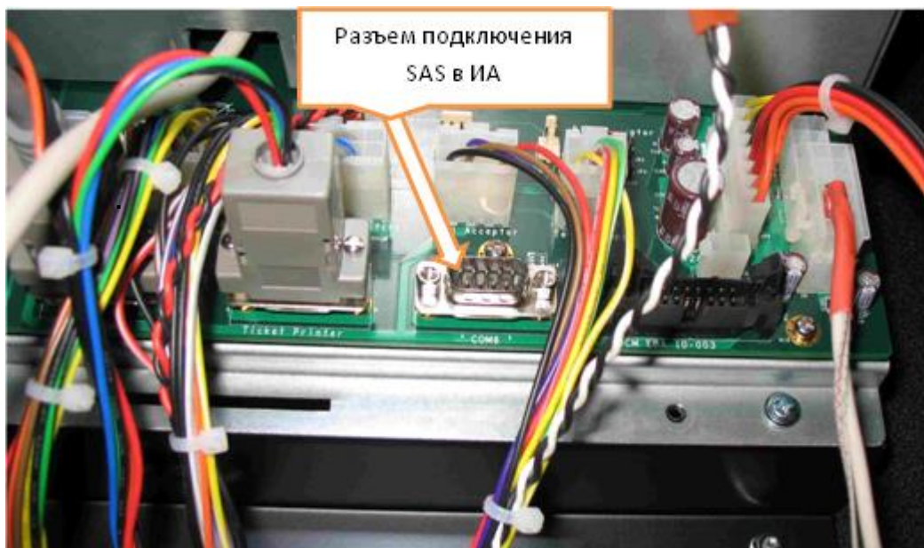
Рисунок 3.4.2 – Подключение канала SAS КИА в ИА.
