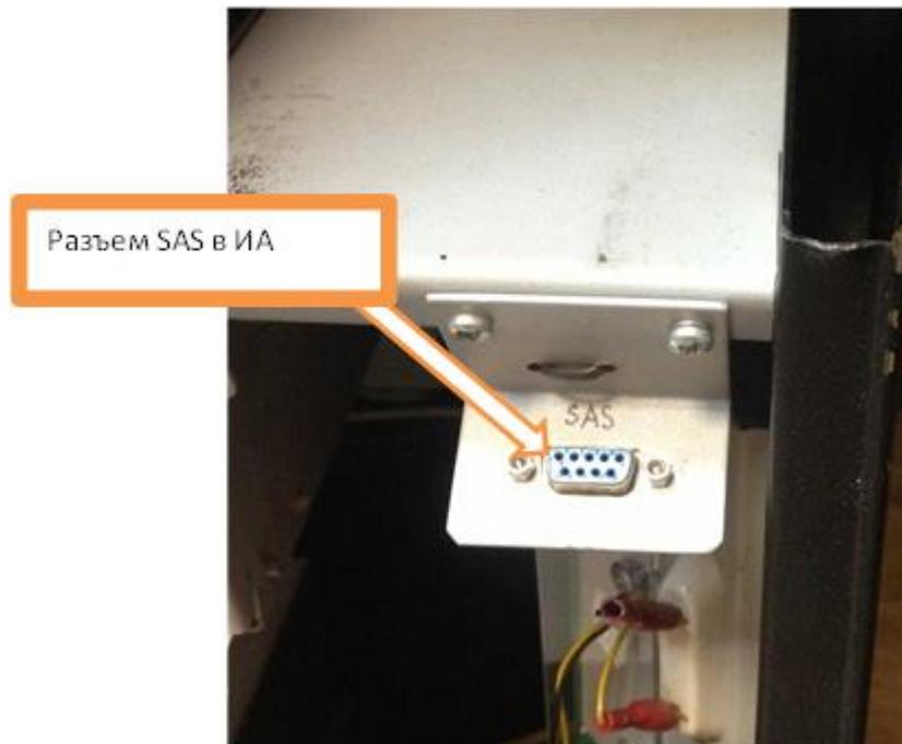
Рисунок 3.4.2 – Подключение канала SAS в ИА.
