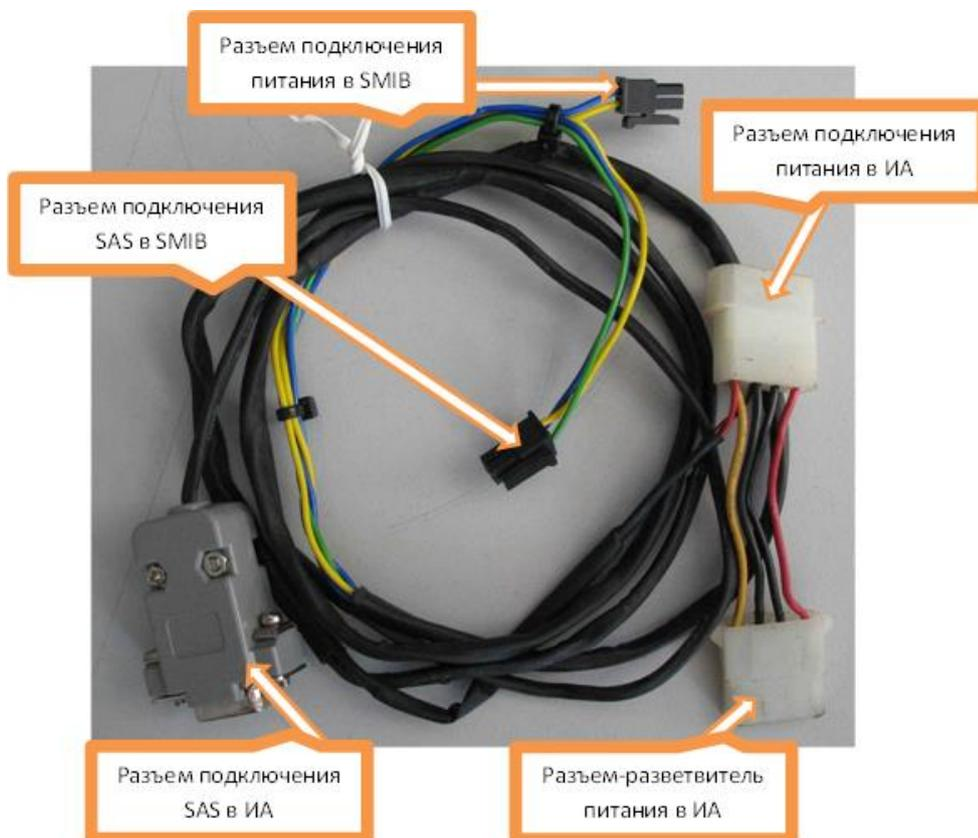
Рисунок 3.4.3 – Кабель соединительный RuI 09M-04
