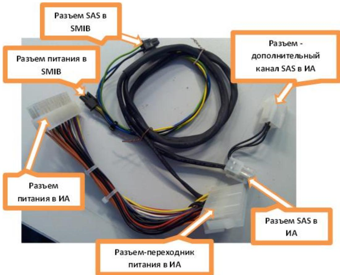
Рисунок 3.4.2 – Кабель соединительный **Bel 01**
