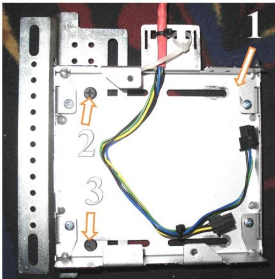
Рисунок 3.2.1 Установка кронштейна платформы KIA
